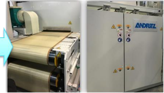
Four Fonte de la fibre thermoliante pour « coller » les fibres entre elles et refroidissement pour fixer le produit
