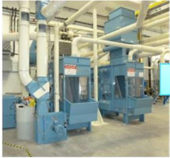
2 Ouvreuses – peseuses « Casse » les amas de fibres (ouvraison) et pèse les constituants
