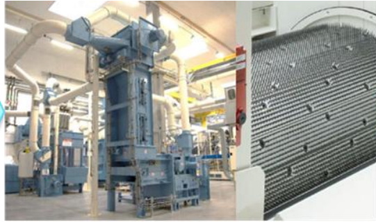
Ouvreuse fine Homogénéise le mélange de fibres isolants / thermoliantes. Passage dans des rouleaux avec pointes fines pour tirer et mélanger les fibres
