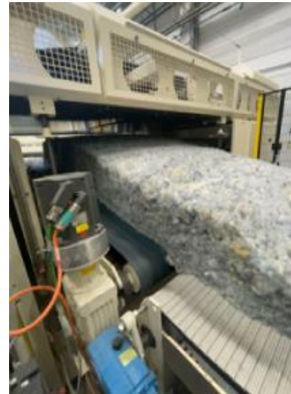
Airlay Mise en place du matelas de fibres (nappage) avant cuisson pour une densité et une épaisseur données. Projection par soufflage des fibres et maintien de la nappe par aspiration
