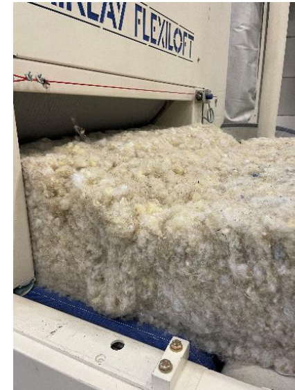
Airlay Mise en place du matelas de fibres (nappage) avant cuisson pour une densité et une épaisseur données. Projection par soufflage des fibres et maintien de la nappe par aspiration
