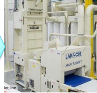
Airlay Mise en place du matelas de fibres (nappage) avant cuisson pour une densité et une épaisseur données. Projection par soufflage des fibres et maintien de la nappe par aspiration
